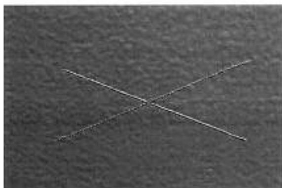
Segundo teste de aderência realizado no CP 1. Classificação X_0/Y_0 (0 % de destacamento).
